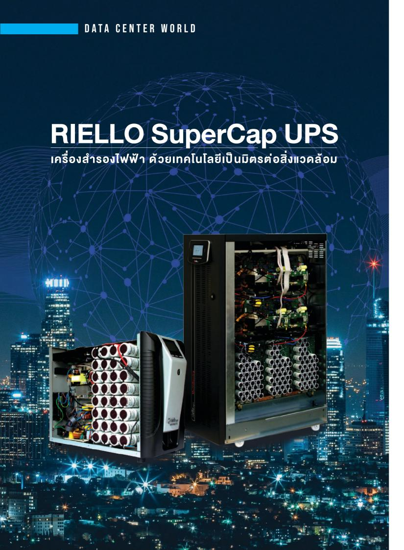
เครื่องสำรองไฟฟ้า (UPS) ด้วยเทคโนโลยี Super Capacitor คือ เครื่อง สำรองไฟที่ใช้พลังงานจากการคายประจุไฟฟ้าจาก Capacitor นำมา จ่ายไฟฟ้าให้กับโหลดในช่วงขณะที่ไฟฟ้าหลักดับ (Emergency Mode) แทนการใช้แบตเตอรี่ที่มีข้อจำกัดเรื่องอายุการใช้งานที่สั้น และราคาค่า เปลี่ยนแบตเตอรี่ที่มีมูลค่าสูง โดยแบตเตอรี่ที่หมดอายุการใช้งานยังจัด เป็นขยะที่มีพิษอีกด้วย
